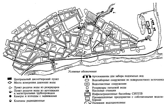
Рис. 1. Принципиальная схема устройства системы хозяйственно-питьевого водоснабжения
